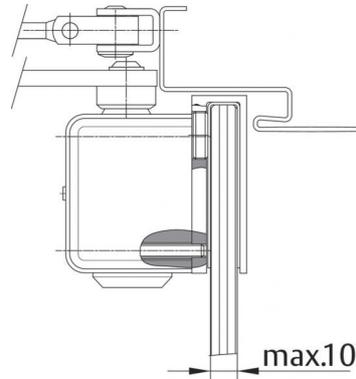
Für die Türschließermontage am Vollglastürblatt.
