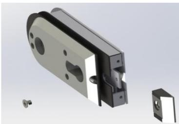
7. Flüsterfalle um 180° drehen und wieder an dem Schlosskasten montieren.
