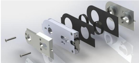
4. M5 Innensechskantschraube herausdrehen und den Schlosskasten in Einzelteile demontieren.
