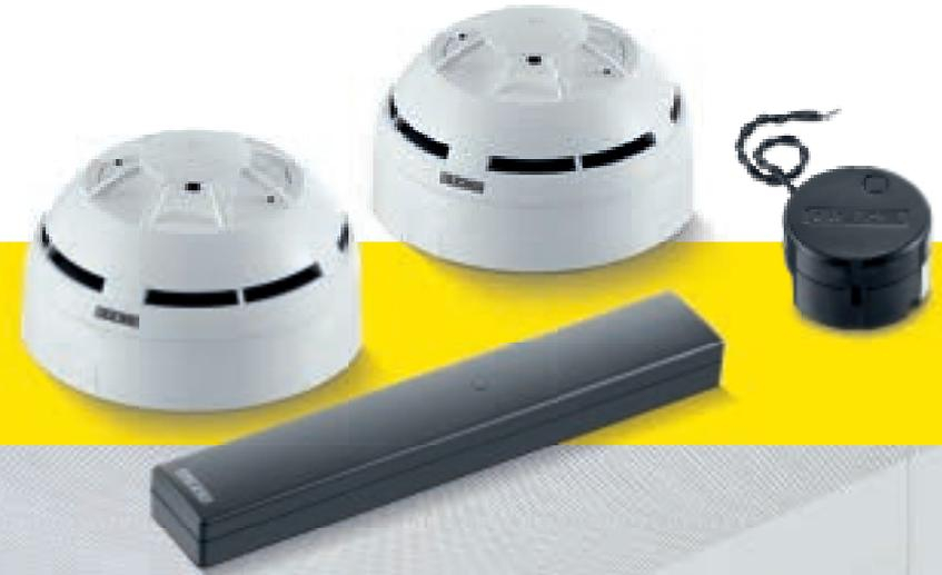
Mit dem Funkmodul GC 171 können nun zusätzlich Komponenten für Feststellanlagen wie Deckenbrandmelder und Handauslösetaster per Funk mit der Feststellanlage verbunden werden. Eine separate Leitungsverlegung zu diesen Komponenten entfällt damit. Das System eignet sich somit insbesondere bei Installationen in denkmalgeschützten Bauten oder zur Nachrüstung in Bestandsbauten.
